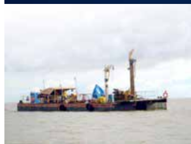
Balsa de sondagem com os equipamentos no mar em São Luís/MA
